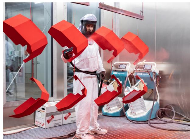
Primer sowie Deck-Pulverlack werden manuell in einer begehbaren Kabine aufgetragen.
